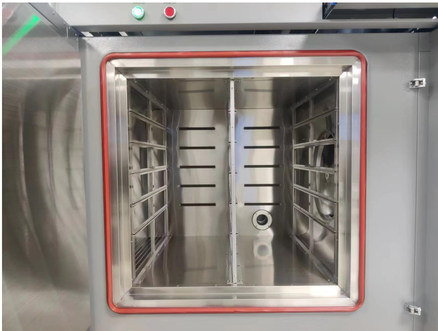
(图 4) 温箱内部结构图
