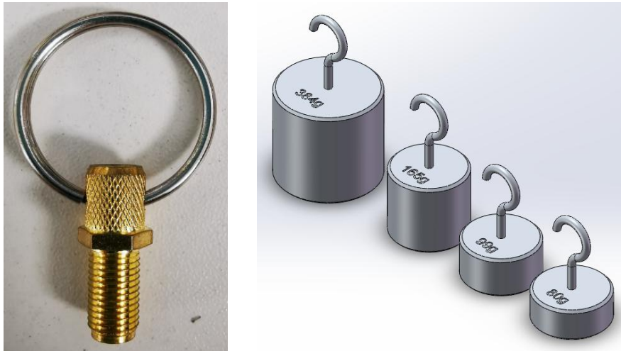
(图 8 C) 拉力砝码组件示意图 (左为挂环, 右为砝码主体)
