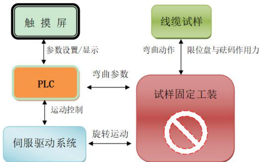
(图 3) 工作原理方框图
