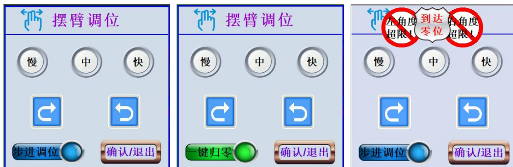
(图 14) 设置界面(左边两图显示步进调位与一键归零功能；右图为限位/零位提示图)
