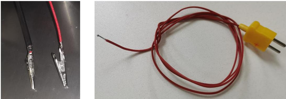
(图 18) 试样电压监测线 / 热电偶线
